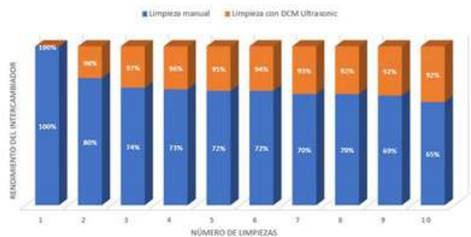
RENDIMIENTO DE UN INTERCAMBIADOR CON LIMPIEZA MANUAL VS DCM ULTRASONIC
