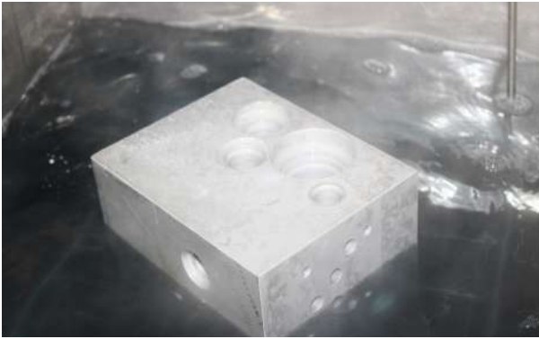
Limpieza de un cuerpo de válvulas de un robot industrial
