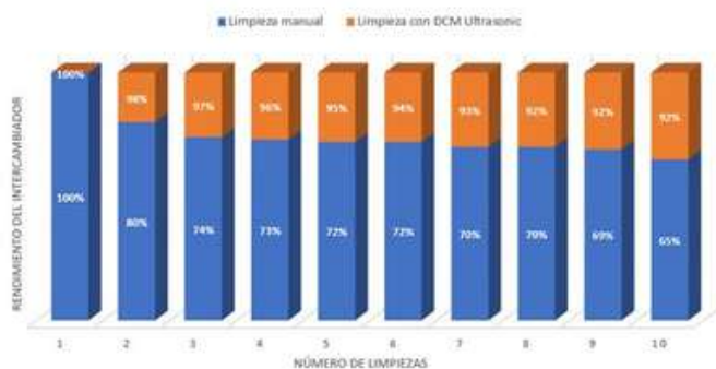
RENDIMIENTO DE UN INTERCAMBIADOR CON LIMPIEZA MANUAL VS DCM ULTRASONIC
